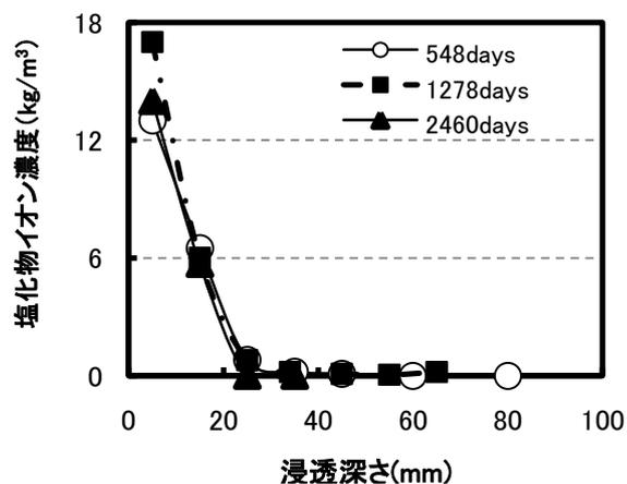
図-1 フライアッシュコンクリートの遮塩性能を示す一例<sup>1)</sup>
