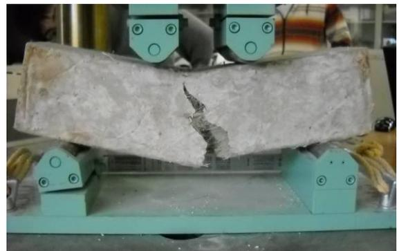
写真-1 大型供試体の曲げ試験
