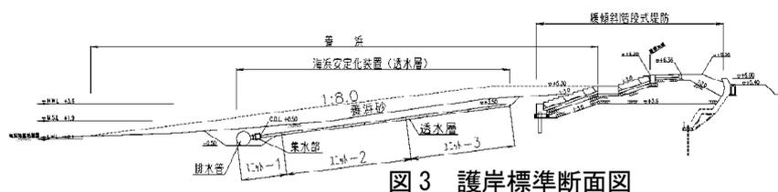
図 3 護岸標準断面図
