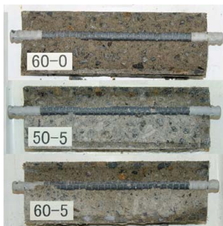
写真-2 水の浸透状況(供試体割裂面)
