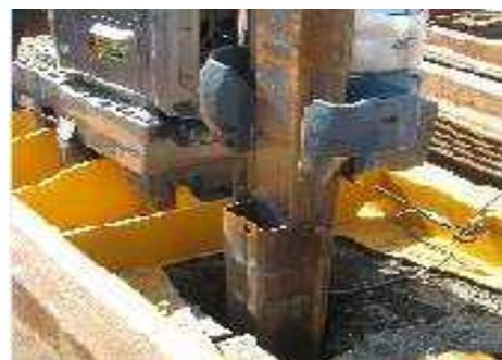
写真1 矢板を用いたサンプリング
