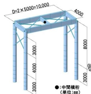
図1 ダンパー設置後のイメージ(1径間)
