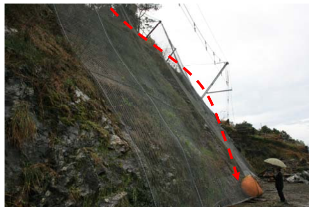
写真-2 重錐の落下軌跡
