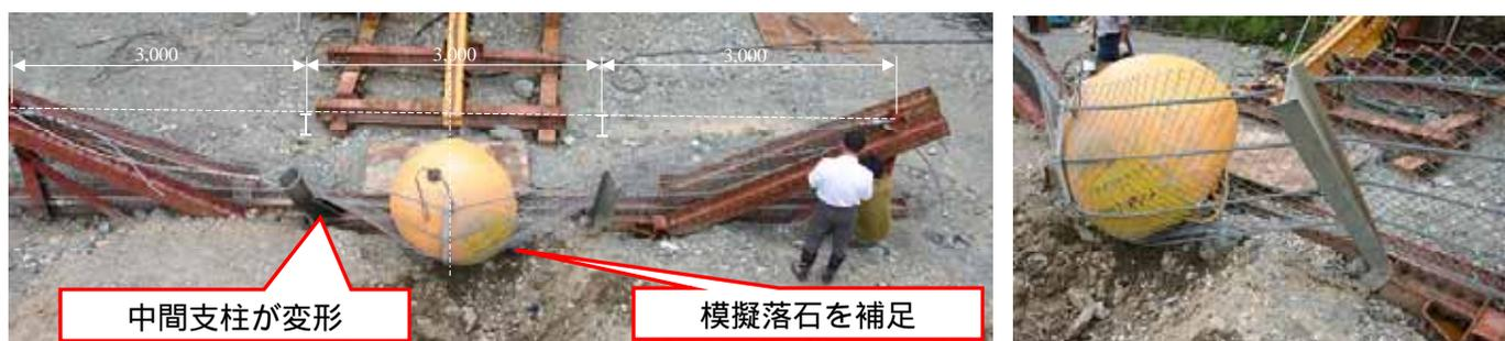
写真-4 衝突後の模擬落石補足状況
