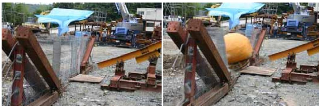
写真-3 衝突前(左)と衝突の瞬間(右)
