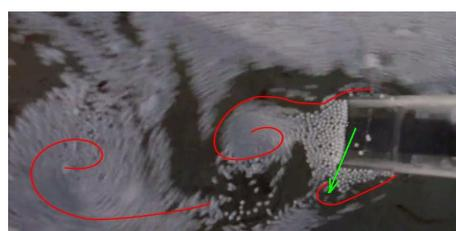
写真-4  $F_x-FM$  の正の最大ピークとその次の正のピーク間の最小値での流れ場
