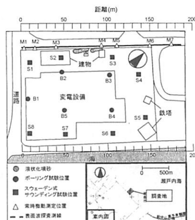
図-1 調査地点の位置、周辺状況、液状化噴砂、表面波探査測線、微動測定地点
