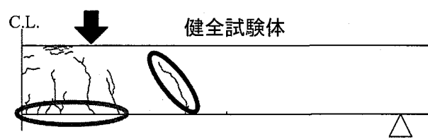
図-3 健全試験体のひび割れスケッチ
