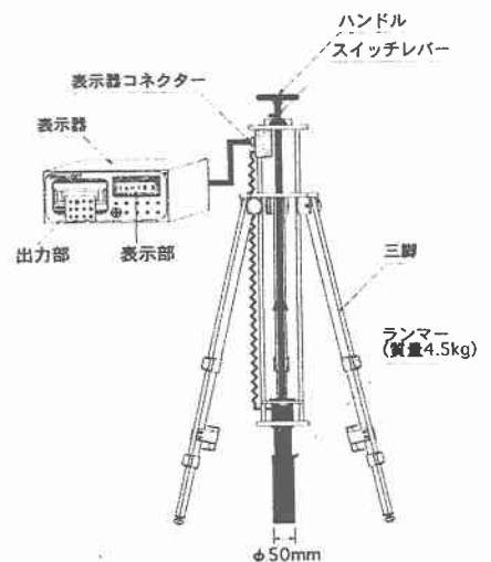
図-1 簡易支持力測定器の概略図
