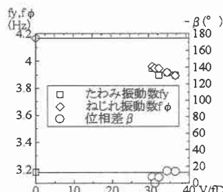
図4 フラッター発生時の振動数と位相差
