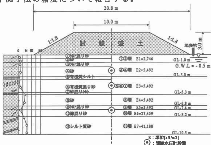
図-1 試験盛土断面図
