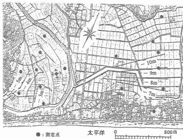
図-4 測定点および淡塩境界面の深さ
