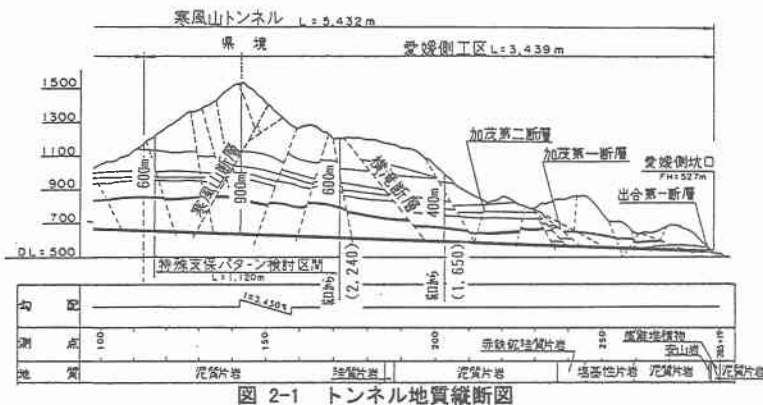
図 2-1 トンネル地質縦断面
