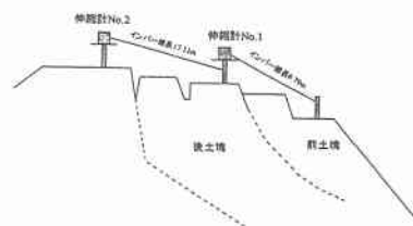
図-4 伸縮計の設置
