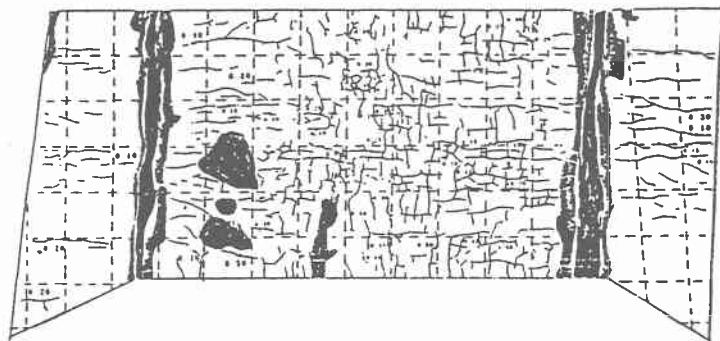
図-1 頂版下面の外観変状図
