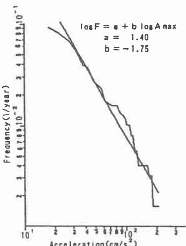
図-4 応答加速度の頻度の回帰
