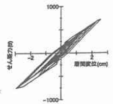
図-7 トリリニア型による履歴減衰
