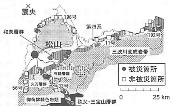
図-1 松山管内の国道斜面の点検と被災箇所
