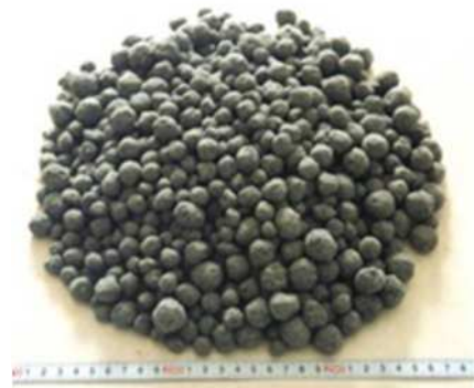
図 1. 石炭灰造粒物 (Hi ビーズ) の外観
