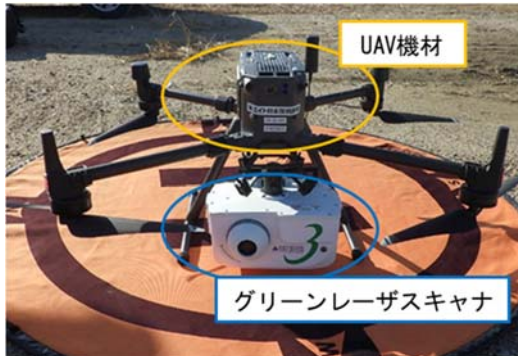
図2 水中を透過するグリーンレーザ光を照射するスキャナを搭載した UAV の概観
