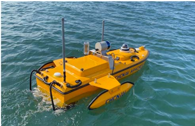
図4 ラジコンボートを使ったマルチソナー計測器の概観
