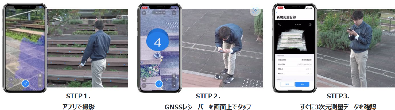
図-1. モバイル端末を用いた点群測量
