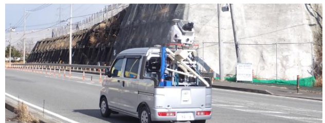
図-3 MMSを用いて法面点群を取得している様子
