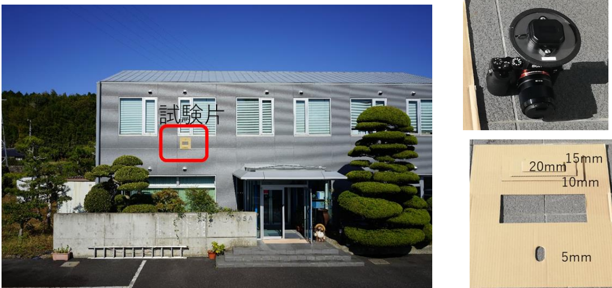
図 1 精度検証に使った供試体と設置状況および使用したデジタルカメラの概要
