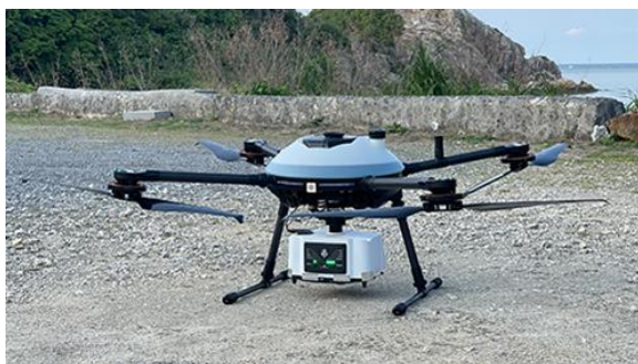
図1 ドローンに搭載する発電機の概観
