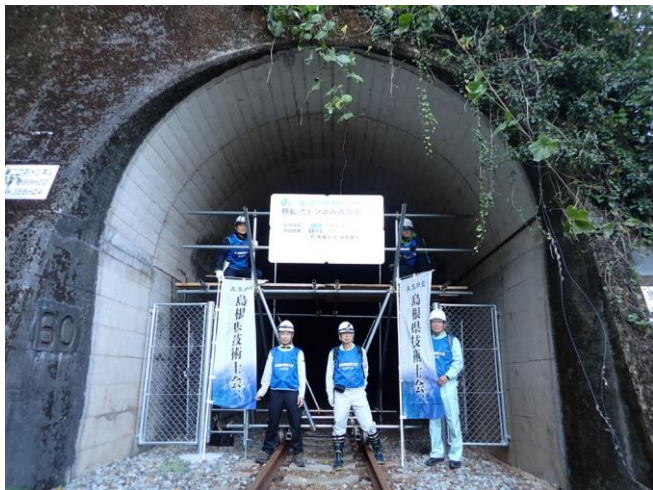
写真-12 試作したトンネル点検車
