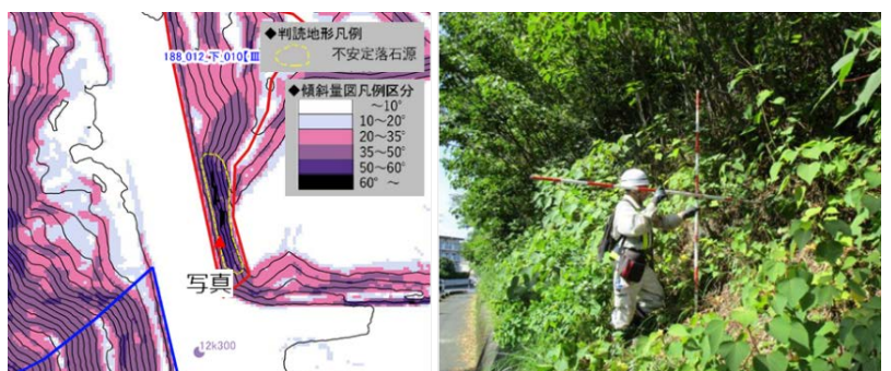
図-5 植生影響による過剰抽出箇所の現地確認例 植生の影響を受け、傾斜量が実際よりも急傾斜で作図される。
