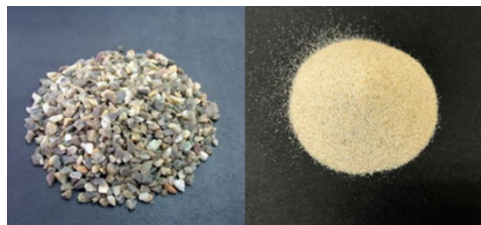
写真-1 宇部珪砂 3号 A(大粒子)と豊浦砂(小粒子)
