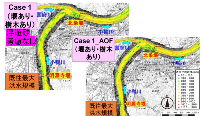
図-5 浮遊砂考慮有無別の表層平均粒径平面分布(既往最大流量)
