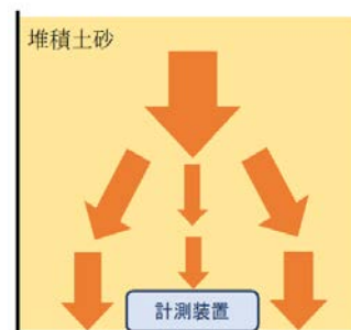
図-3 圧力分散の概念図
