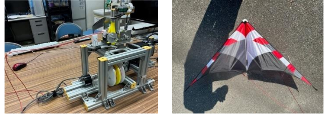
写真1 カイト飛行制御装置とカイト
