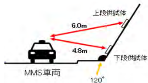
図-2 計測時のMMSと法面の状況
