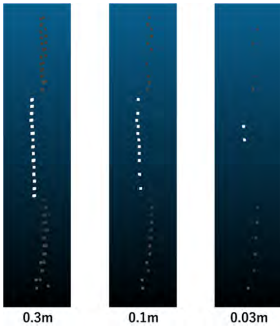
図-9 50 mm厚の供試体を見た法面の断面図 図中の数字は切り出し幅を示す。 1 回だけの MMS データを使った場合
