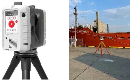
図-4 地上レーザスキャナと計測状況
