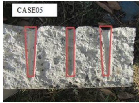
写真2 スタッドジベル引抜後の供試体
