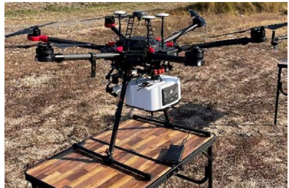
図-1 グリーンレーザドローン測量システム
