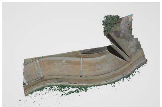
図-1 河川堤防法面 点群データ
