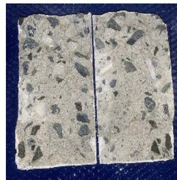
写真-1 割裂面における含浸材浸透深さの測定
