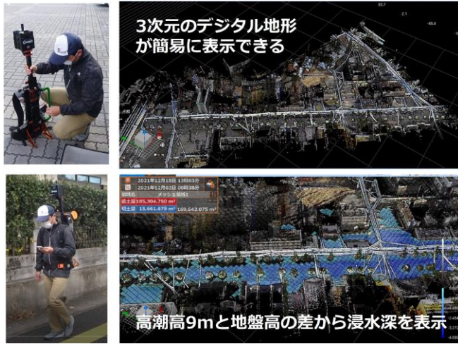
図3 GEOSLAMの計測と点群データ解析および浸水深表示
