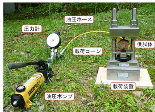
図-1 点載荷試験（応用地質(株)製 Model-4326）
