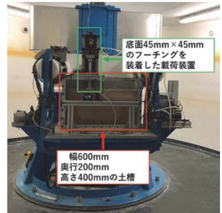
図-1 土槽および載荷装置を装着した遠心力模型試験装置
