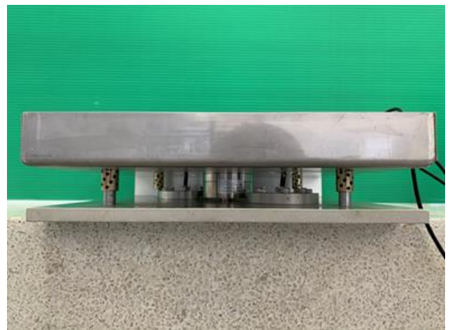
写真-1 防護壁に設置した荷重計
