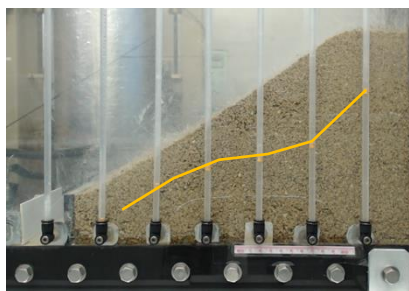
写真-1 実験時間5時間後の盛土表面と各水頭の様子
