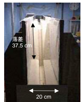
図-3 下流から見た水路
