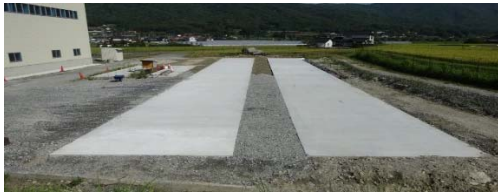
写真-4 フィールド試験の CRCP 供試体
