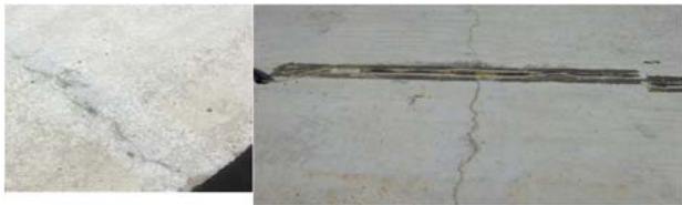
写真-3 ひび割れ結果 (左:Type A, 右:Type B)
