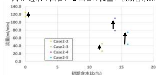
図-6 透水 5 回目と 6 回目の流量と初期含水比
