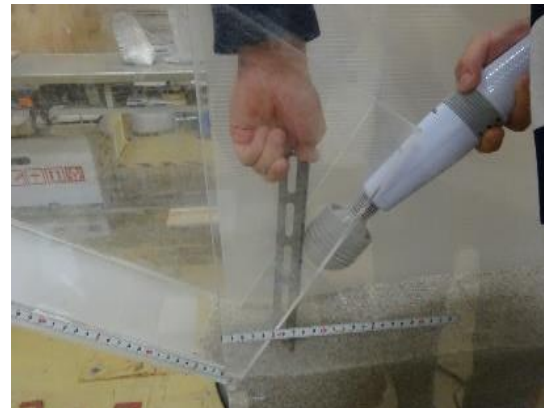
図3 締め固めの様子
