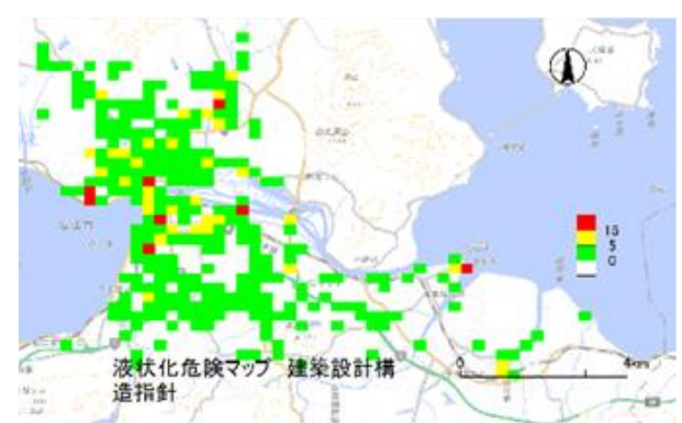
図5 液状化マップ (建築基礎構造設計指針)
