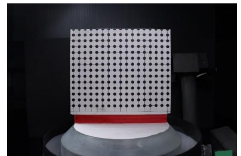
図-4 幾何補正用基準標点
